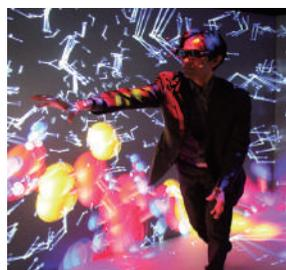
兵庫県立大学大学院シミュレーション学研究科にある「3D-CAVE」装置の見学をしました。3D-CAVEは、3次元のコンピュータ・グラフィクス画像をインタラクティブに見ることができる装置です。6畳程度の部屋の4面がスクリーンとなっており、そこにゲームで用いるようなコントローラーを手に持ち、シャッターを高速で切り替える立体メガネをかけて入ります。今回の見学会のために、鷺津研のM2の中江理緒君と、M1の勝川了一君が水圏機能材料のモデル分子の分子動力学シミュレーションを実施し、その立体動画の中に入れるようにしました。時々刻々原子の配置は変化していきますが、炭素 - 炭素の結合を見据えるとニューマン図で学んだように分子鎖の揺らぎが特定の配置をもって実現することや、水素結合らしき水の原子とポリマーの酸素原子との位置関係が見られ、体験者は大興奮の3次元動画でした。
